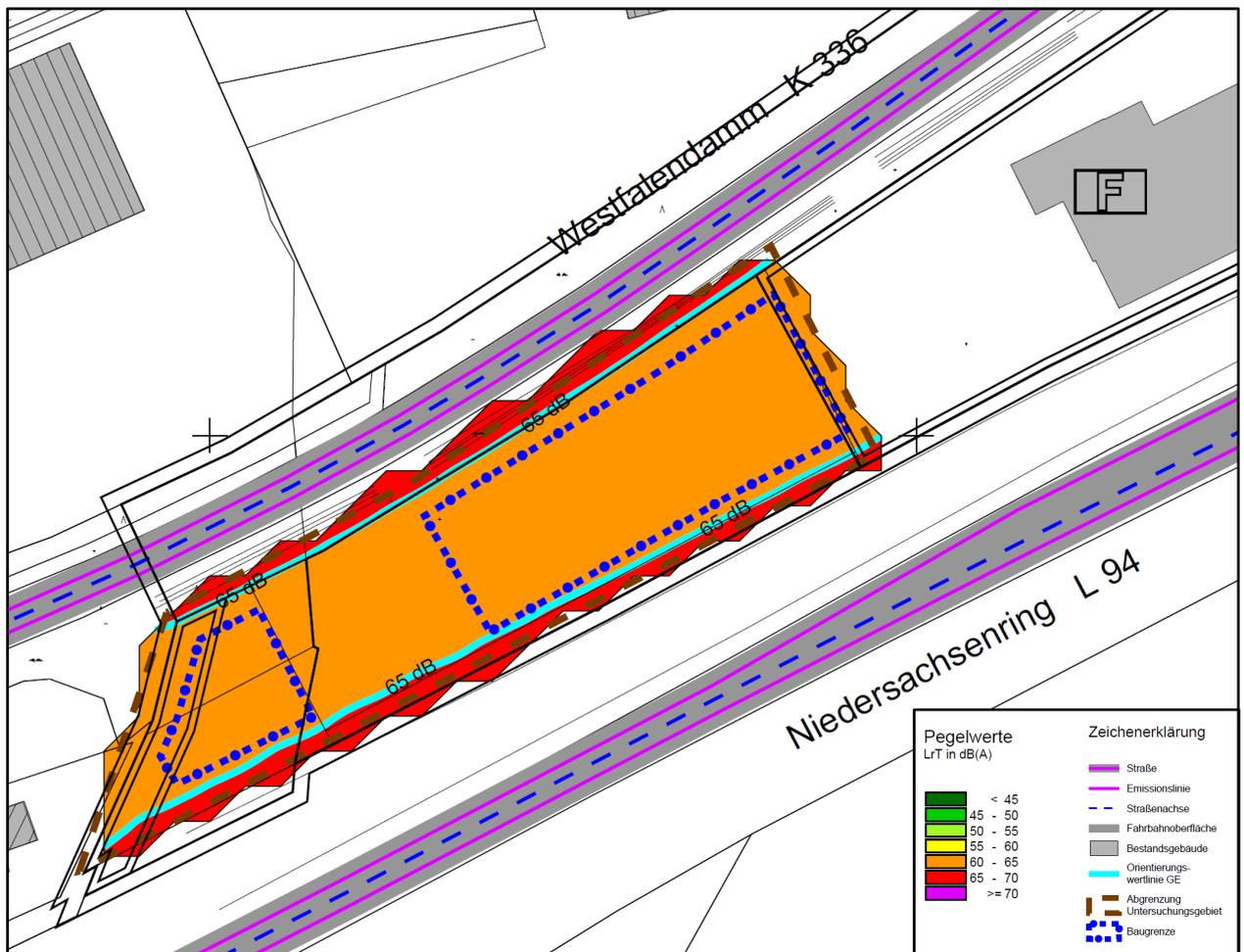
Bild 4: Auszug aus der Isophonenkarte 2.1 Tag (6-22 Uhr), 5 m über Gelände, ohne Maßstab
