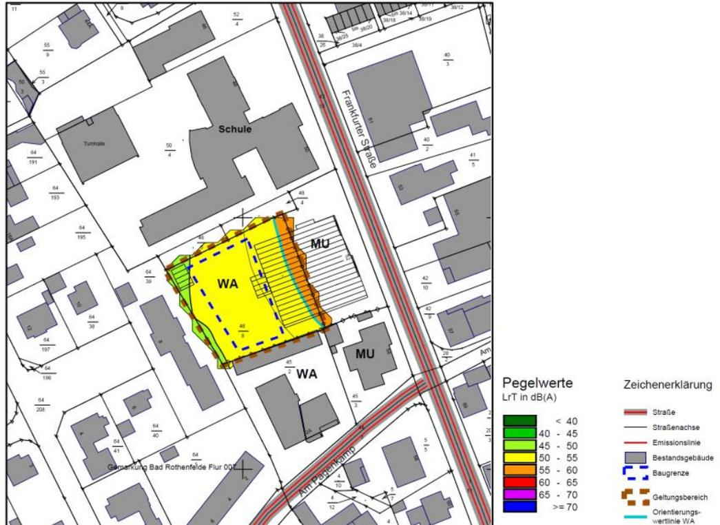
Abb.: Isophonenkarte Tag, Berechnungshöhe 4,0 m (Auszug aus der Karte 1 des Fachbeitrages Schallschutz), ohne Maßstab, genordet
